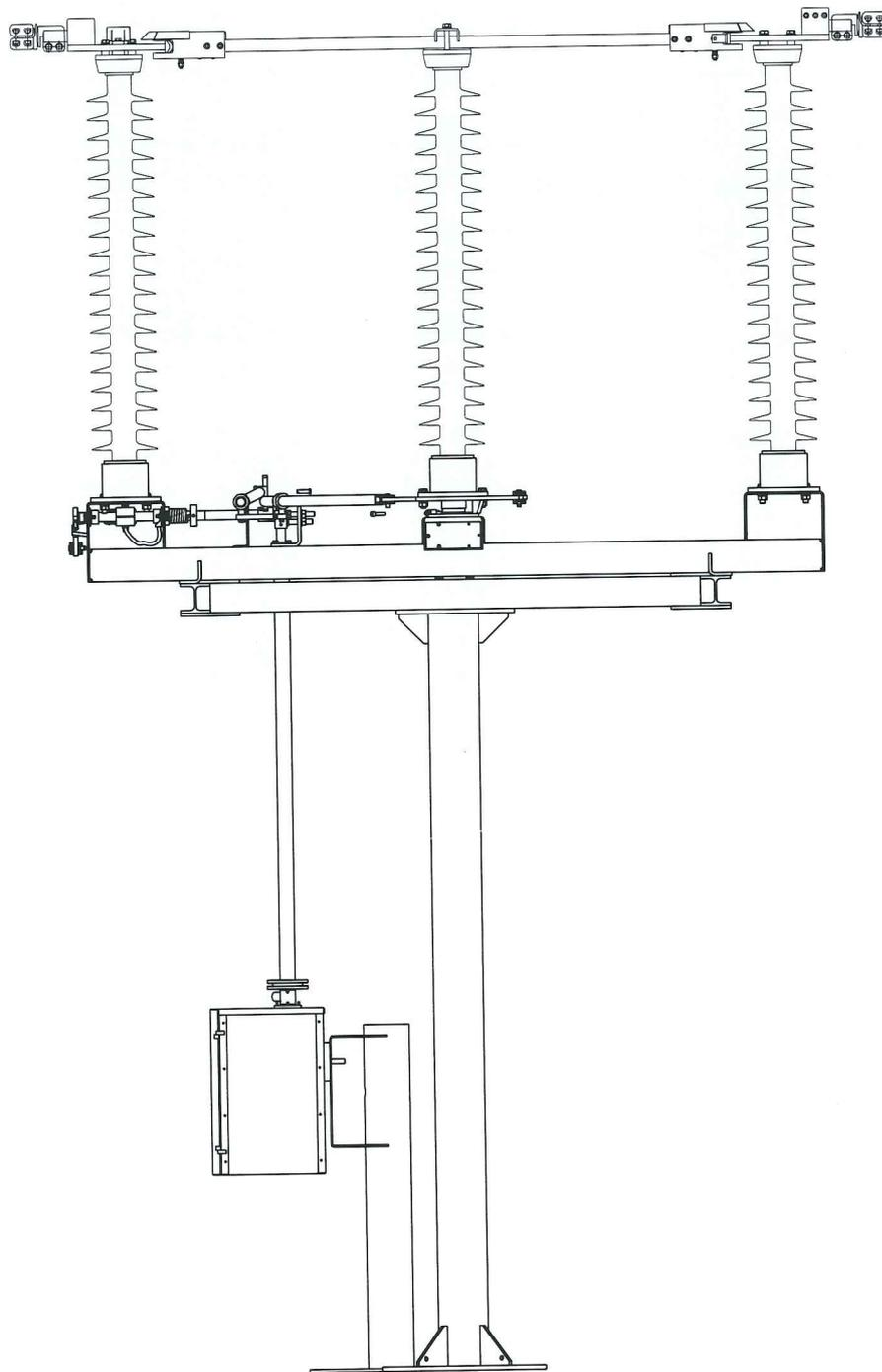
N°1 SEZIONATORE TRIPOLARE ORIZZONTALE 132 kV
