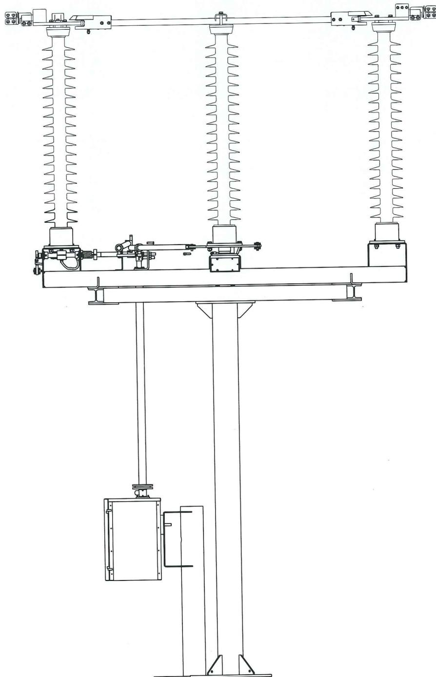
N° 1 SEZIONATORE TRIPOLARE ORIZZONTALE 132 kV
